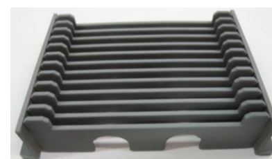
ストープ部材へのコールドスプレー法によるNiAl皮膜
