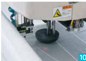
9 10 アートカッターは平成26年に「ものづくり補助金」を活用して導入。CADデータに基づいて必要な生地の幅や長さを読み取り、バキュームをかけて正確に素早く裁断していく。生地は3cm厚まで対応可能。
