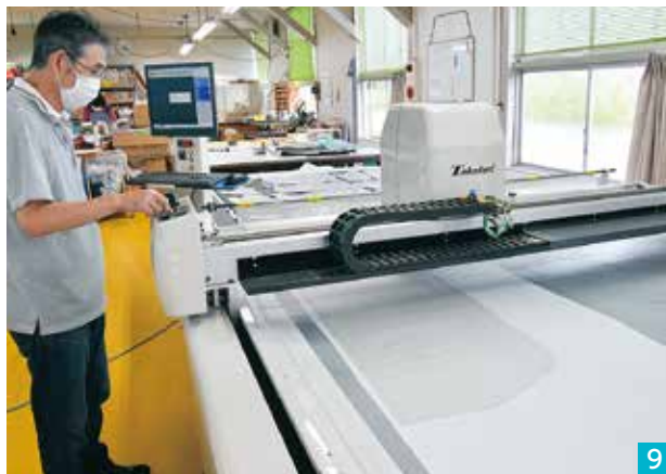
9 10 アートカッターは平成26年に「ものづくり補助金」を活用して導入。CADデータに基づいて必要な生地の幅や長さを読み取り、バキュームをかけて正確に素早く裁断していく。生地は3cm厚まで対応可能。
