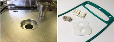
当社では寸法・形状の検討段階から、実際の量産まで対応可能です。試作金型で作った製品で十分にご検証を頂けますので、複雑な形状でも量産のスムーズな立ち上げが可能です。また大型の真空成型機が多数御座いますので、取り数の大きな金型で量産が可能です。
