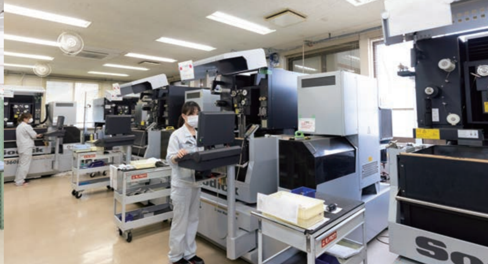
図面をもとに、ワイヤーカット加工機で部品を製造
