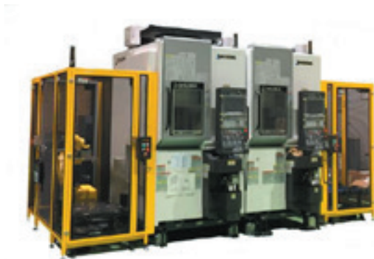
材料投入用ロボット+5軸制御立型マシニングセンタ×2台+完成品取出し用ロボット
