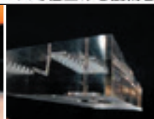
アクリルの鏡面穴加工 左（製品サンプル）中（ストレートとテーパ穴）右（クロス穴）
