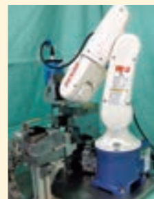
ネジ締め自動化用 ネジ保持機 有限会社 サワ (花巻市)
