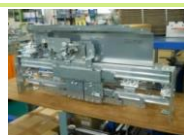
ホームエレベータードア開閉
