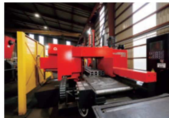
設備貸与制度を活用したバンドソーで高精度高速自動切断が可能になり生産性も向上
