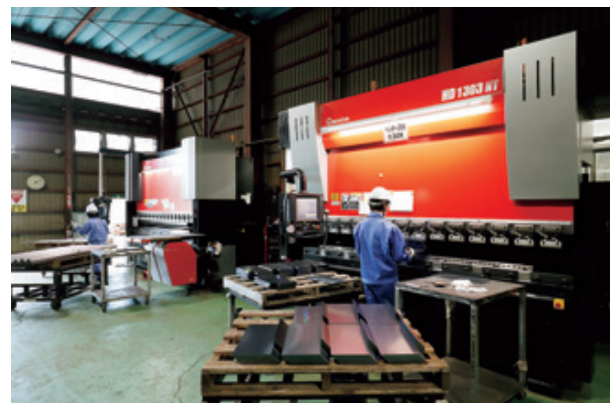
曲げ加工のベンダーもタッチパネル式。若手も外国人実習生も扱いやすい
