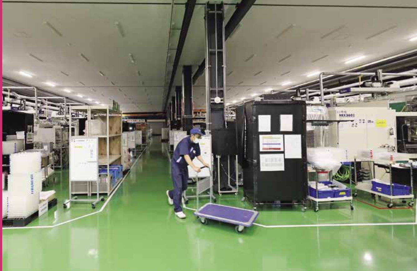
工場内は広く、余計な光が入って反射しないように暗めにし、傷などが見つけやすいようにしている
