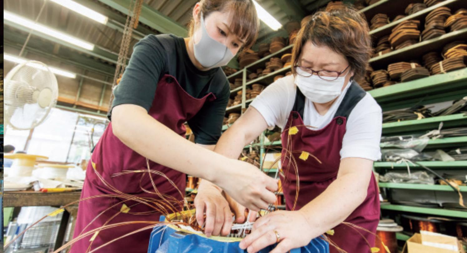
モーター内部のコイルの巻替え作業
