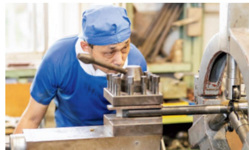
旋盤で調整しながらパーツの金属加工を行う
