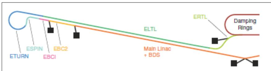
図 3.5 RTML 全体図（電子の E が頭文字、陽電子側も殆ど同じ）<sup>4)</sup>
