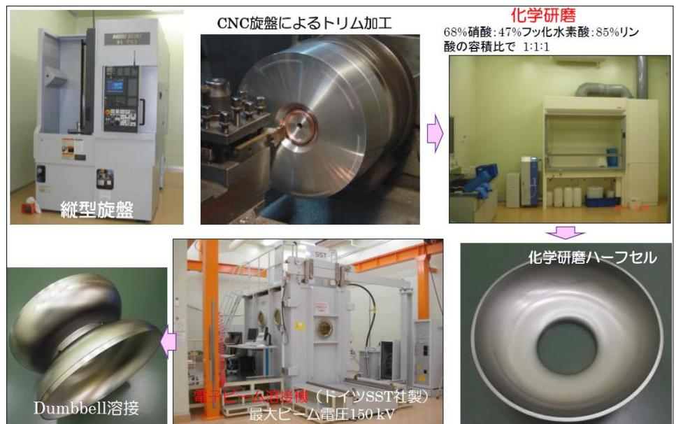
図4.6 トリム加工、化学研磨、ダンベル溶接<sup>8)</sup>
