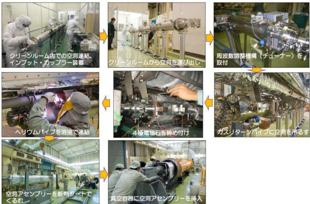
図 4. 23 クライオモジュールの組立工程<sup>5)</sup>
