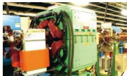
図 3.26 四極電磁石<sup>10)</sup>
