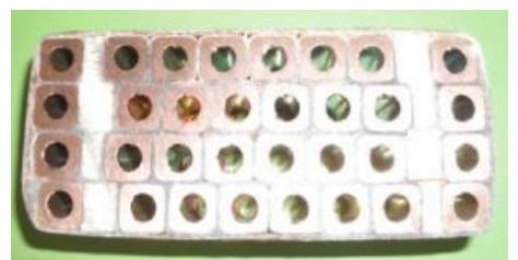
図 3.32 直接水冷式コイルの例<sup>10)</sup> 図 3.33 直接水冷式コイルの断面<sup>10)</sup>
