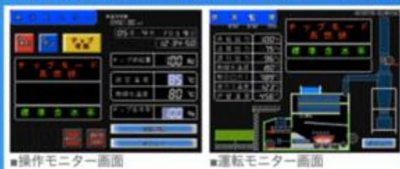
稼働状況、各種温度データ、アラーム履歴等を記録し、運転管理をサポートします。
