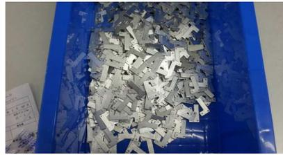
パワーステアリング用モーター制御部品
