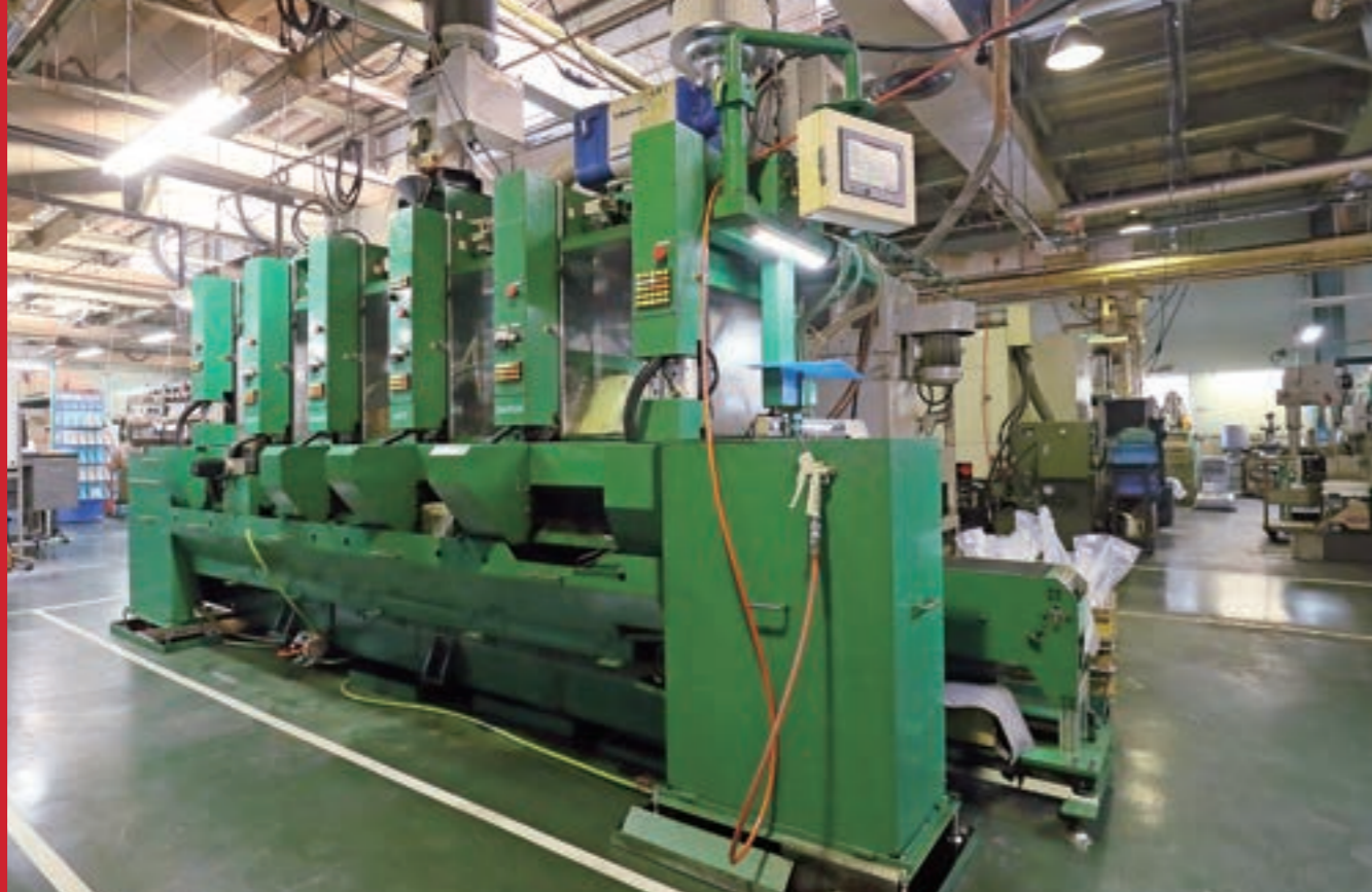
自動で金属に溝を刻む旋盤機
