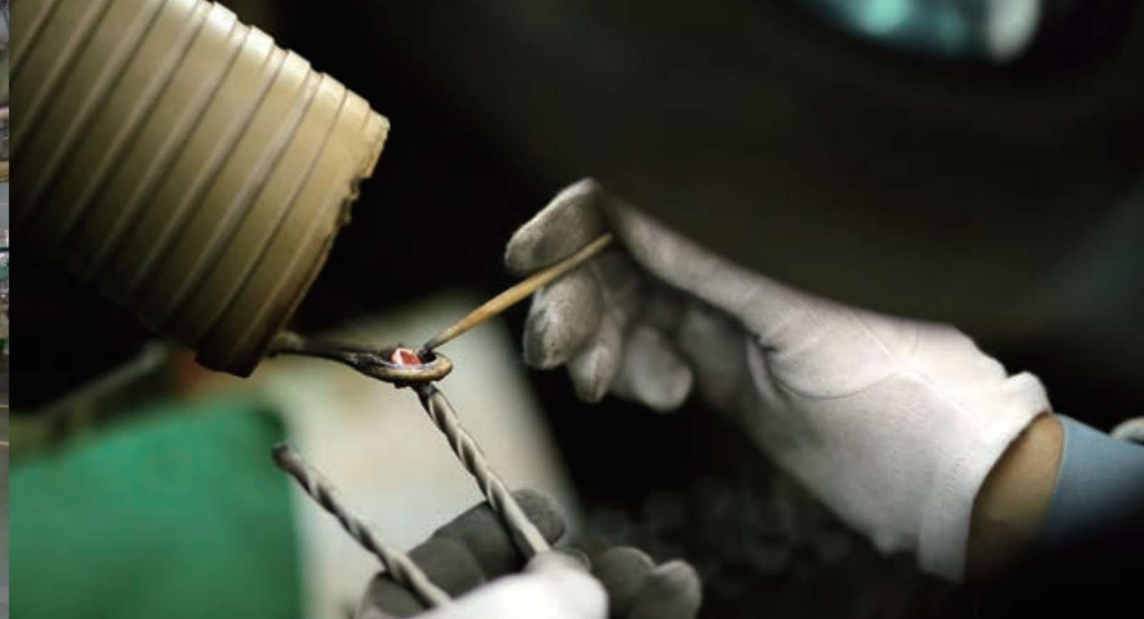
現在、刃先の金属は一つひとつ手作業で張り合わせている
