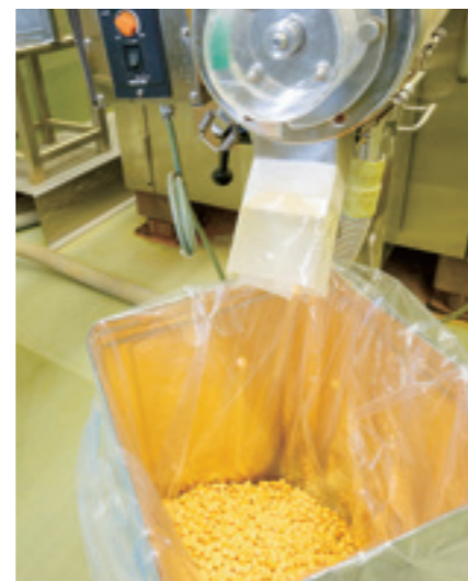
機械の上部から原料の粉を入れ、打錠機で製造されたサプリメント
