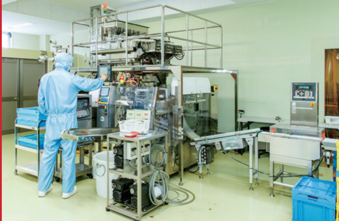
ぶら下げてディスプレイできる、アルミパウチの袋詰めまで行う充填機。現在同様のものを3台揃えている
