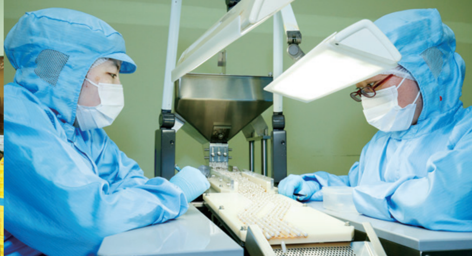
二人一組で、カプセルのはまり具合を目視で確認している
