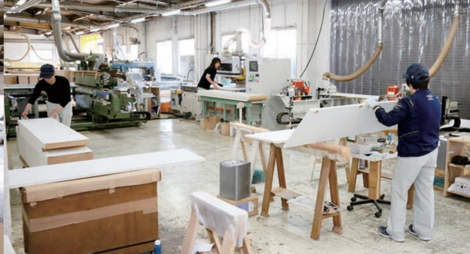
工程改善によって、省スペースで4つの作業を行っている収納扉のライン
