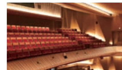
音を分散させるために、Vカットの技術でできたリップ材は、美しい講堂の内装材を兼ねた
