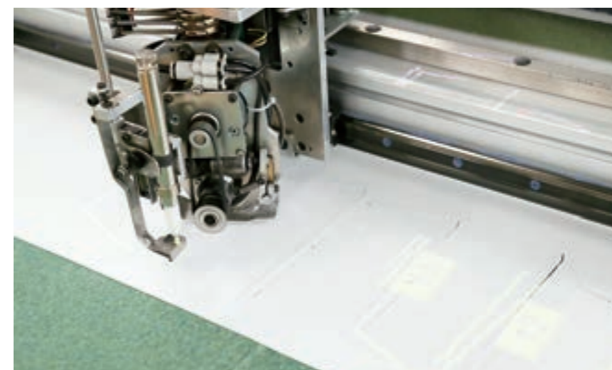
レーザーでカットするラインが描かれ、パーツが切り抜かれる
