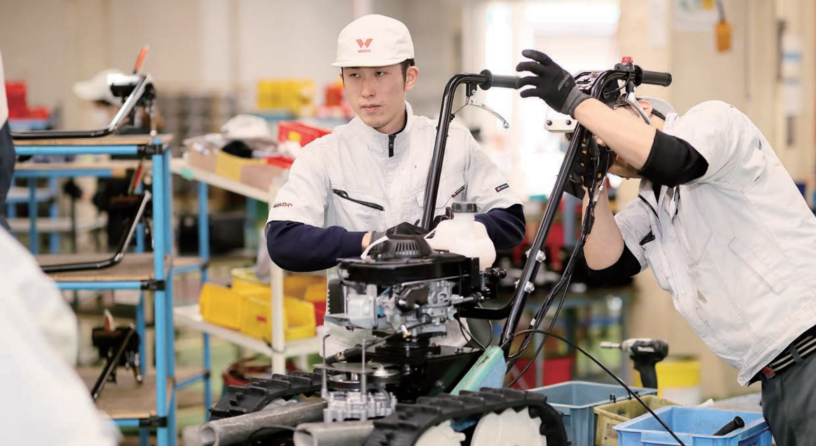
1時間10台を目安に流れ作業で製品を組んでいく小組工場
