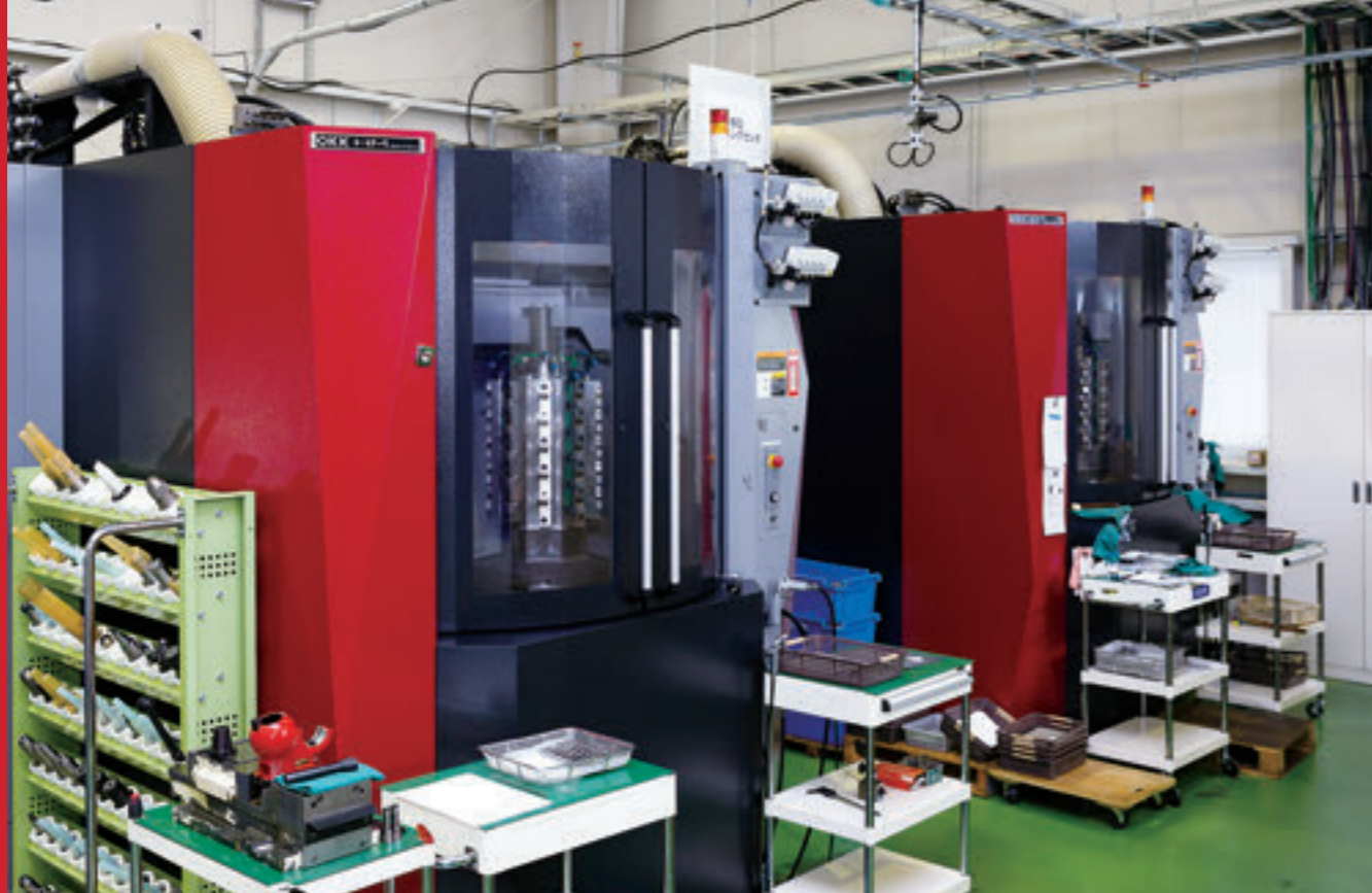
横形マシニングセンターを導入。金属部品の量産加工が可能になる
