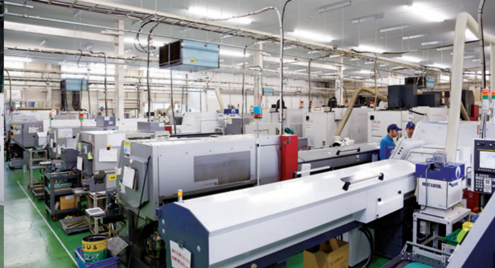
CNC複合自動盤、一本の金属の丸棒から多種多様な部品を製造できる
