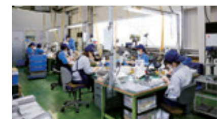
従業員の目視によって製品にキズや歪みがないか、ひとつずつ確認を行う
