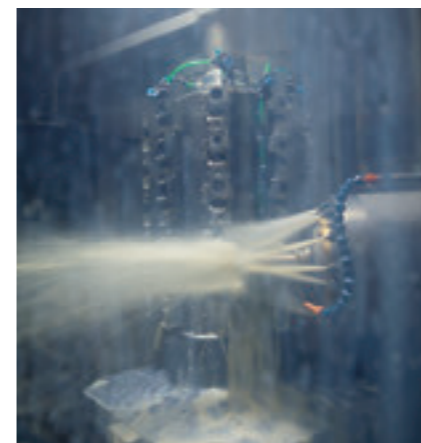
コンピュータによる数値制御で、専用の刃物を回転させながら金属を削る
