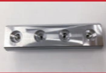
部品の中を通る液体・気体の流量を微調整する機能が果たせるように、バルブシート面の品質を顕微鏡を使って1個1個検査しています。
