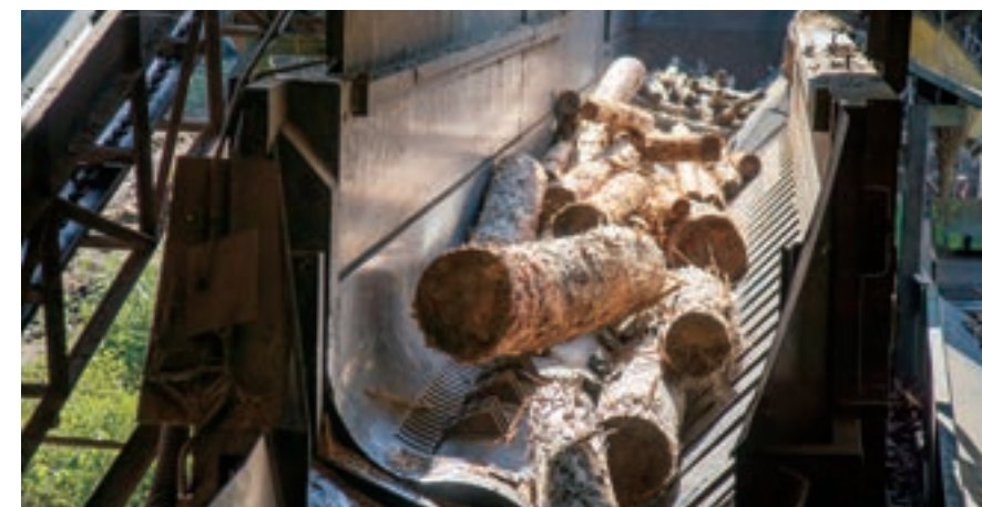
チップに使用する木材の樹皮を、自動で剥離する
