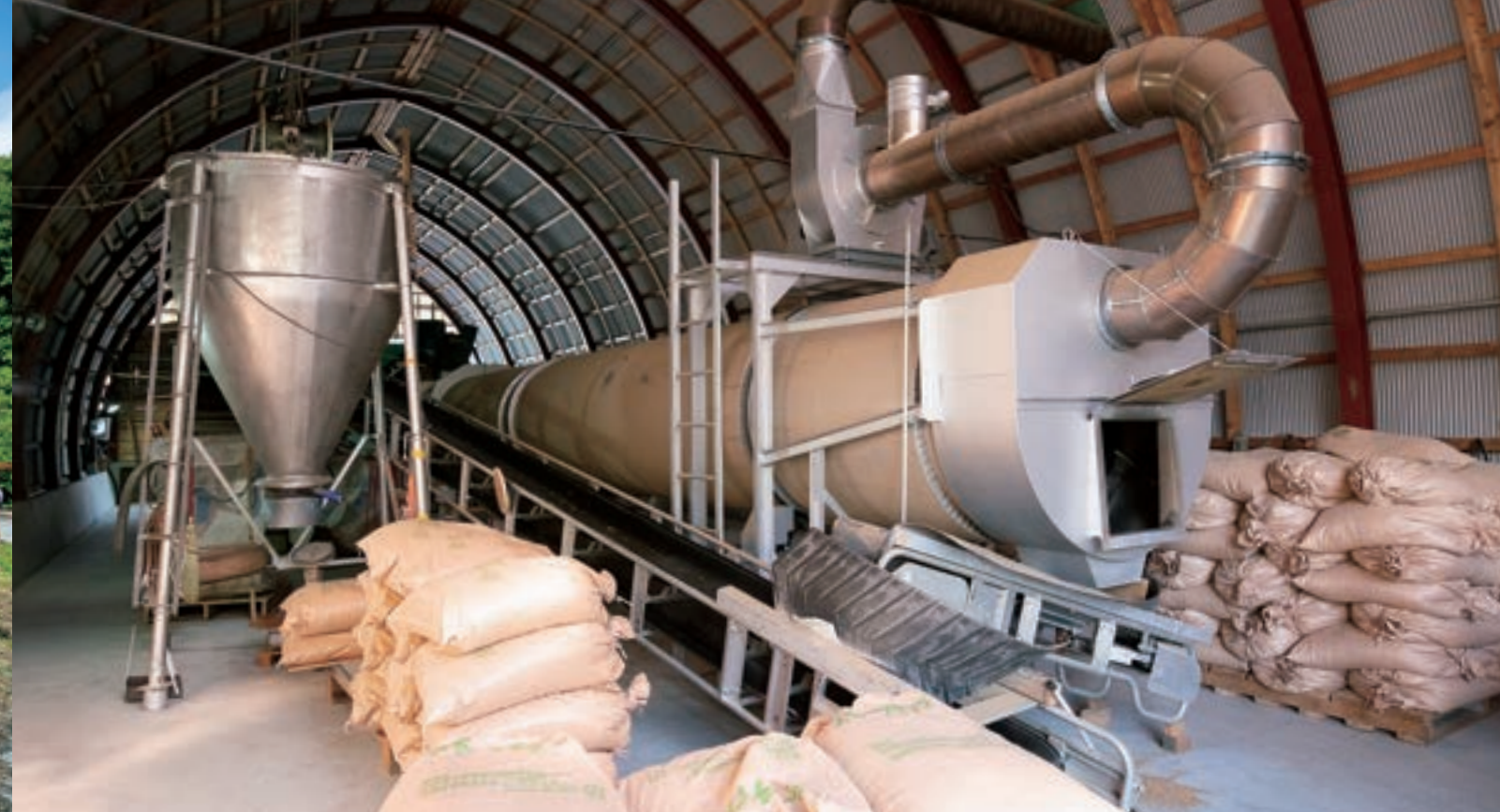
チップの投入から、乾燥、袋詰めまで行う、新事業のスモークチップの最終工程
