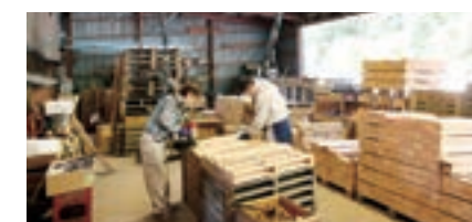
パレット製造工程。自動的に釘止めする設備はあるが、小さいタイプは手動で製作することになる。だれもがいろいろな仕事をできる多能工で臨機応変に対応している
