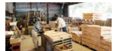
パレット製造工程。自動的に釘止める設備はあるが、小さいタイプは手動で製作することになる。だれもがいろいろな仕事をできる多能工で臨機応変に対応している
