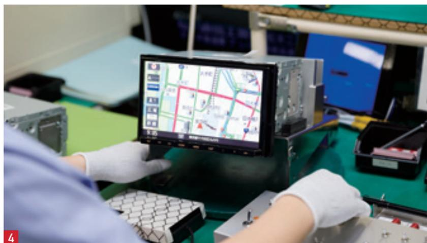
1 工場内には、資格保有者掲示板など、個々の人材形成に関する展示も多い。2 海外研修生には、タブレットで動画を見せて覚えてもらう。3 手のひらに収まる製造された基板のひとつ。表紙のパーツがこのなかに搭載されている。4 組立が終わった主力製品のカーナビゲーションのモニターチェック。
