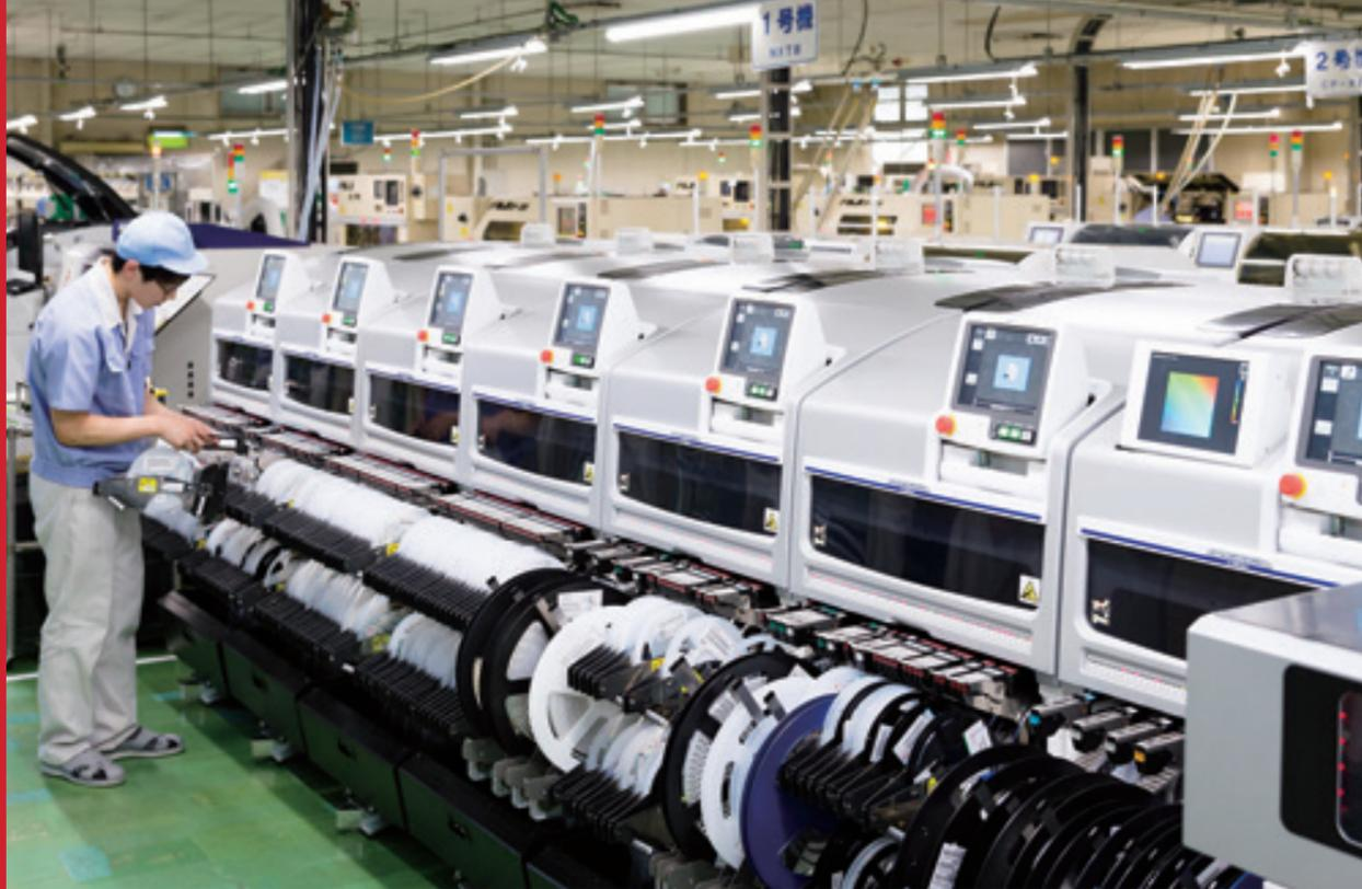
最新のチップマウンター。奥に基板の投入口があり、自動的にクリームハンダが塗られ、基板のうえに搭載されていく。人の手が必要となるのは、リールの交換などごく一部。
