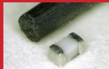
写真の黒い棒は比較のためのシャープペンシルの芯0.5mm。芯が巨大に見えるマウンターで搭載される0.6mm×0.3mmのチップコンデンサ部品。
