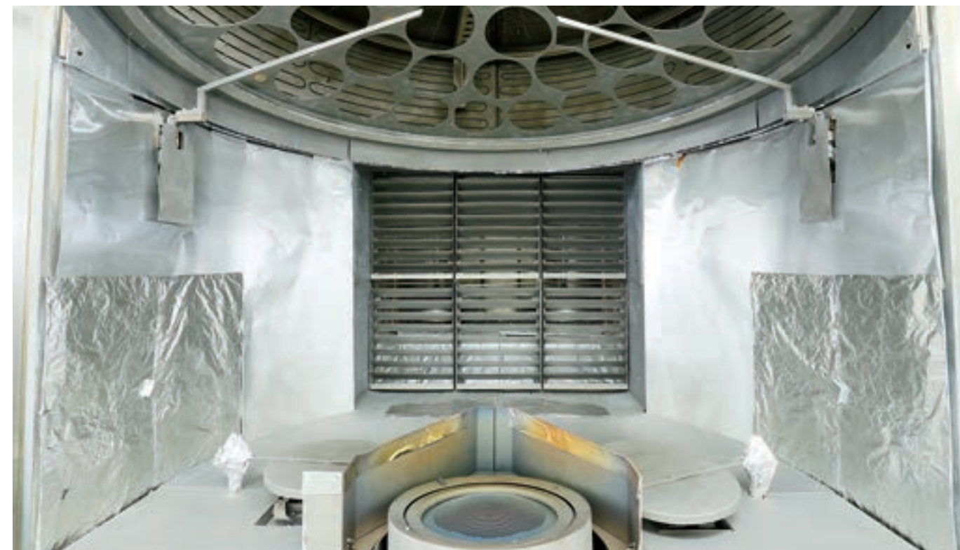
真空薄膜形成装置の内部。天井の丸い部分に基板がセットされる。真ん中の手前がRFイオン装置。
