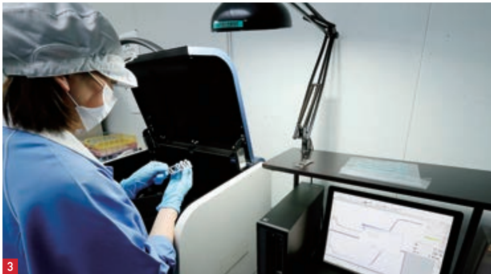
1 真空薄膜形成装置内の上部。基板をドームという器具の天井部にセットする。中心軸でドームを回転させることで、同じ段内で均一な成膜が可能になる。2 蒸着製品の形状は平板の他にプリズムやキューブなど用途によってさまざまな形がある。3 製品の分光特性を測り、お客様の要求値を満たしているかチェックして出荷する。
