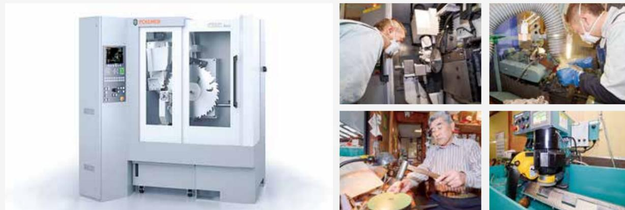
①東北で唯一導入 ドイツ製高性能研磨機 (VOLLMER CHC-840) ②平成28年導入のドイツ製自動チップソー研磨機。従来の4工程の研磨を1工程で行える。③チップソーは大きくなると遠心力により本体に歪みが生じる。これをハンマーで叩いて歪みを直す「こし入れ」は吉田社長にしか出来ない熟練技術。④吉田社長をトップに3人の熟練の職人が研磨作業にあたる。⑤ドイツ製加工機械と同時に導入した全自動研磨機。
