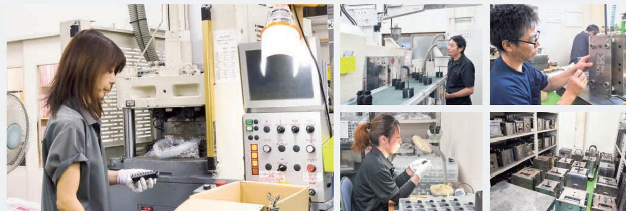
①機械への金属部品のセッティングは人の手で行われ、ひとつひとつ丁寧に成形されている。②③樹脂の種類や形状など作る部品により作業時間も変わる。成形から検品まで、常に人の目が光る。④⑤プラスチック成形の元になる金型。成形が続くと金型内にガスが溜まり樹脂が詰まってしまうこともあるため、定期的なメンテナンスも欠かせない。
