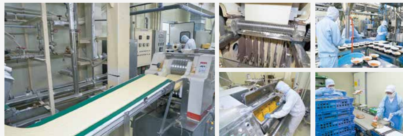
①現在の工場は4階建。最上階でミキシングされた粉は順次下の階に送られ練り行程、圧延行程を経て製品化。うどんには寝かせ行程もある。②麺によって切り刃を使い分けている。③1台で100kgの粉を練る真空ミキサー。④製麺以外は手作業となる調理麺の製造ライン。スプや具材も自社工場で作ることができるのが強み。⑤最も少ない冬場で日産1日約10万食を製造する。
