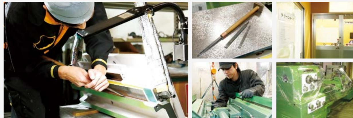
①腰や腕など全身を使って行うキサゲ加工。コンピュータ化が進んでも精度を求める工作機械には欠かせない加工技術だ。②キサゲ加工に使われる工具。素材や形状に合わせて使い分ける。③機械修理は2人1チームで対応。動作確認・精度確認ののち解体、掃除を行い、必要に応じてキサゲ加工、塗装、組付をし、最後に動作確認・精度確認を行う。④平成27年に完成したクリーンルームとレーザー加工室。⑤東日本大震災での機械修理も行った。
