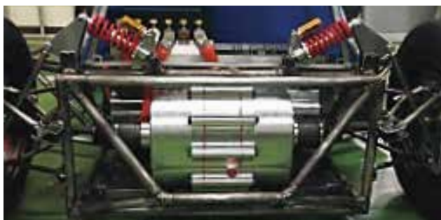
一関高専の特許技術である世界初の装置 2モータトルク差増幅型TVDを搭載。高い旋回性能を誇ります。
