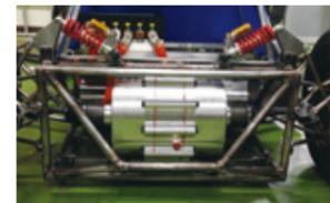
一関高専の特許技術である世界初の装置2モートルク差増幅型TVDを搭載。高い旋回性能を誇ります。
