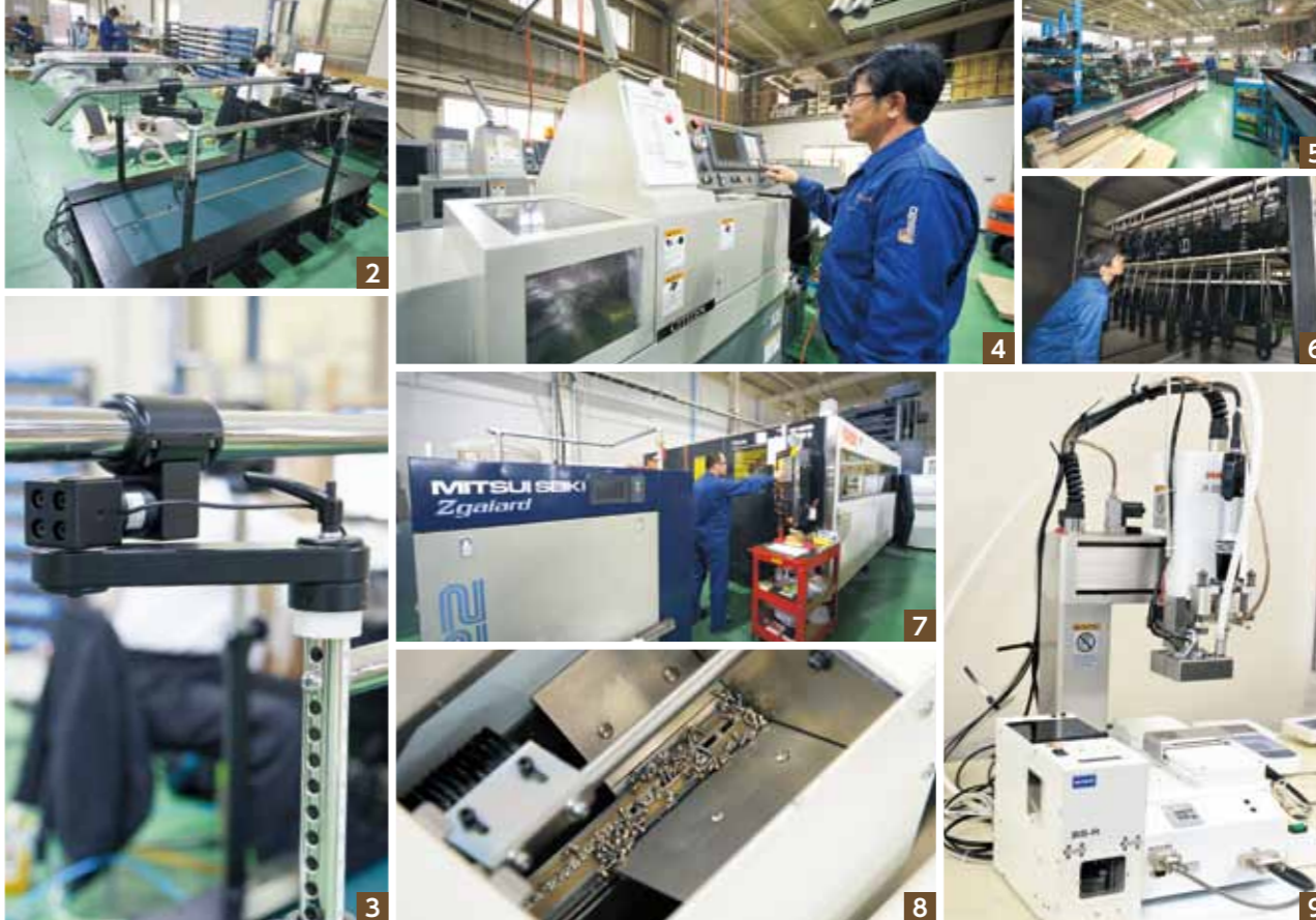
1 業務用トレッドミル製造は顧客の要望に合わせた完全オーダーメイドの世界。大企業が参入しづらい、まさにニッチな分野である。 2 京都の企業と共同で製作された、床反力計内蔵型トレッドミル。プレートやバーにセンサーが付いており、人間の動作を解析できる。床反力計内蔵型は国内製造としては初めてとなる。 3 工場内には自動旋盤やマシニングセンターなどの主要加工機ほか木材加工部や塗装室も備わっており、使用する部品の7割〜8割まで自社加工が可能である。 4 昨年12月に導入された最新のファイバーレーザー加工機。ポンペを使わず空気中から窒素を取り込み部材を切断する機構で、従来のプレス機による打ち抜きと違い加工の自由度が向上し、バリも出ないため品質も向上した。 5 自動ネジ供給機。ネジ詰まりの少ない水平直進フィーダーが技術の核である。 6 エアー圧送式ネジ供給機。外付けユニットからネジをエアーでドライバーの先端に圧送、大量生産の現場で使用されるロボット供給タイプの需要が伸びている。 7 8 9
