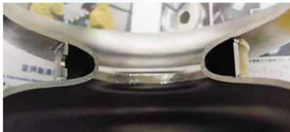
加速空洞断面 サンプル
