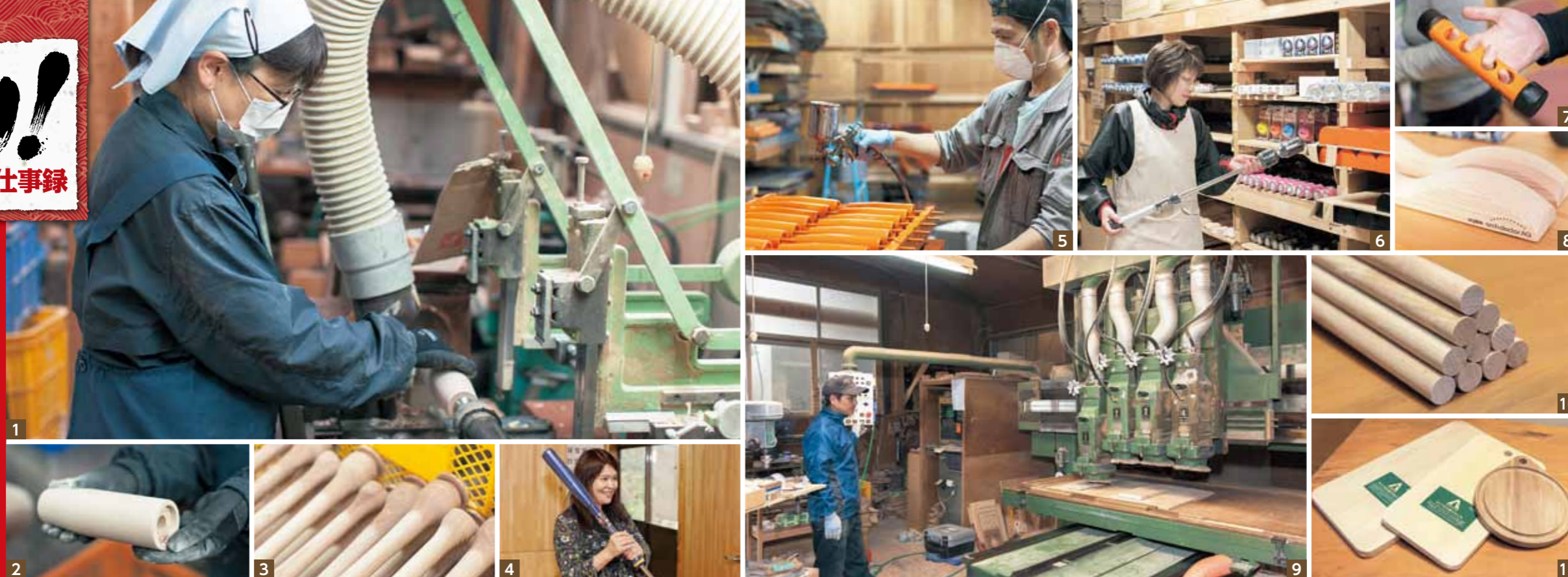
1平成8年に(株)内田木工の販売会社として創立された同社は、平成23年に内田木工と合併。独自の商品開発に力を注いできた。 2実際のバットにも使われているイタヤカエデやタモを使用。トレーニング用にも良材を使うのがこだわり。 4「商品には絶対の自信がある。振ってらえば良さが分かる」と製品を持って全国の問屋を歩いた内田社長。 5⑥第一工場では製材を、第二工場では算盤の球などの半加工品を製造。第三工場がトレーニング用品で、加工から発送まで一貫生産。 7手首、肘、肩の可動域を広げる「フィンガーゴリラ」。 8足裏を鍛える「アーチドクターAQ」。木材加工の技術が生かされた仕上がりだ。 9創業時から稼働するNCルーター。操作する内田社長の弟である内田嘉久常務は、高い技術を持つ職人だ。 10⑩算盤の球となるオノオレカンバの半加工品とロングセラーとなったまな板類。
