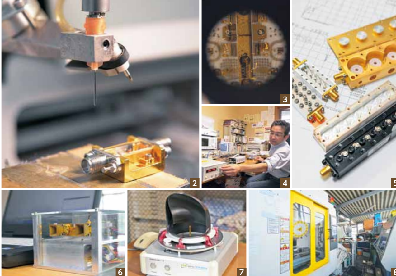
①6台の各種ワイヤ・ボンディング・マシンを所有、マニュアル操作で周波数110GHz以上のミリ波帯機器の製造を手掛ける技術力。 ②回路は3種のボンディング・マシンを駆使し製作。 ③高周波の電子回路は樹脂の代わりにアルミナなどの素材に金の薄膜を付けた基板が使われている。 ④製品は高周波特性測定を経て完成となる。最新の測定器は当センターが認定支援機関となり、ものづくり補助金を利用して購入した。 ⑤自社で切削加工したフィルタ。共振の原理で電波信号の選択を可能とし、携帯電話をはじめあらゆる工業製品の求める周波数や帯域に合わせて作られるため、形状は実に様々。 ⑥社内で試用されるミリ波レーダから偶然、壁内透視が可能なることを発見した。 ⑦(独)電子航法研究所の依頼で製作したミリ波レーダ。 ⑧敷地内にある機械加工部門。多くの依頼が舞い込む。
