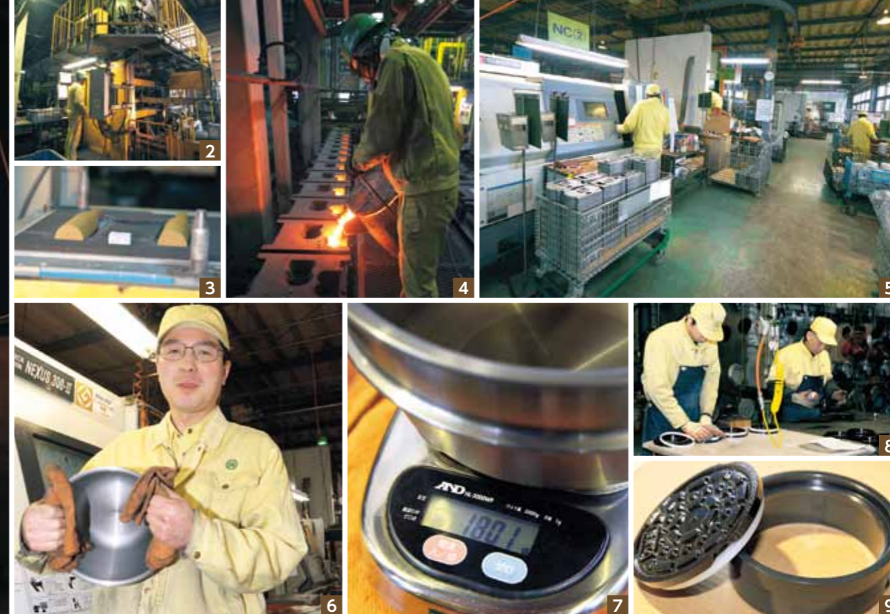
1 600kwの出力を有する高周波誘導電気炉。2基のつばで1500度以上で熔解した鋳物は素早く注湯ラインへと搬送されていく。 2 アルミ模型から鋳型を製造する自動造型機。ホッパーから投入された砂で鋳型を作り、中子をセットするのは人の手で行われる。 3 溶けた鋳物は注湯ラインへ運ばれ、慎重に鋳型に注がれていく。その後冷却・ショットブラスト・研磨などの工程を経て素材が完成。 4 炊飯ジャー内釜の切削・研磨ライン。完成した素材はおよそ7kgあり、ここから本体にセットできるサイズにまで切削していく。オーダーに応えるため独自に切削用治具も開発した。 5 内釜の重量は1800gで誤差は20g以内。高い技術力と職人気質のスタッフが厳しい条件に当たっている。 6 止水栓に塩ビのパイプをセット、製品として納入。
