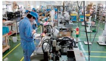
主に、JST部品加工、モレックス製部品加工などを手がけており、半田処理ロボットを導入、迅速な生産体制を敷き、また、徹底した品質管理も行っております。
