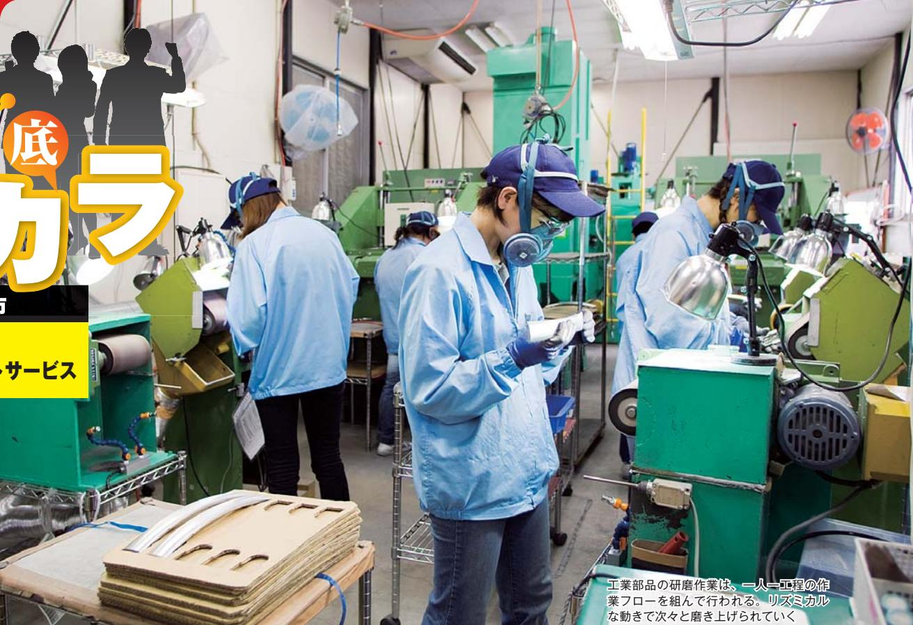
工業部品の研磨作業は、一人一工程の作業フローを組んで行われる。リズミカルな動きで次々と磨き上げられていく
