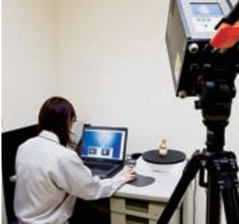
包む相手を3次元カメラで撮影、その画像データで原材料を加工する
