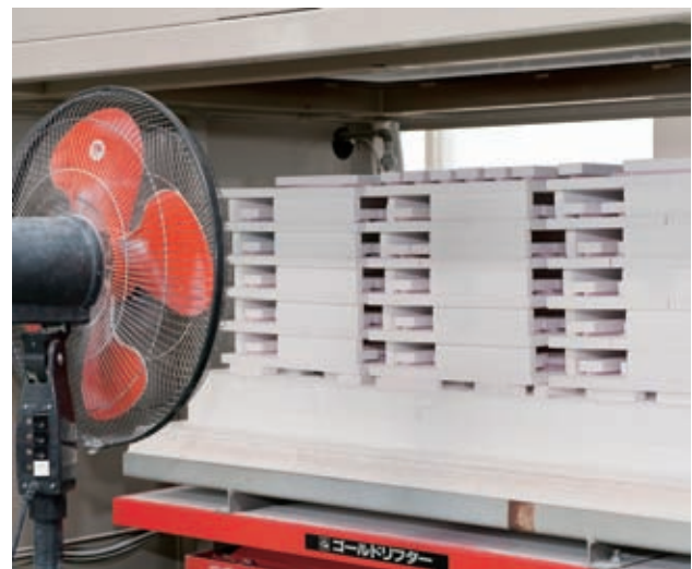
焼結する電気炉。熱によって反りが起こらないように工夫が施されている
