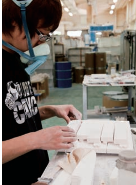
成型された刃材を規則正しく 並べて電気炉に入れる
