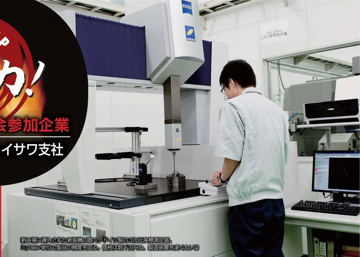
新工場に導入された新鋭機の数々。ドイツ製の3次元座標測定器。ミクロン単位で製品の精度を図る。価格は数千万円と、製造装置を凌ぐという
