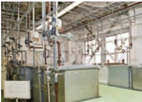
新設の手製めっきライン。配管工事部分に外部の指導を受けた以外はすべて社員の手づくり。このラインで自動車部品の生産を行う
