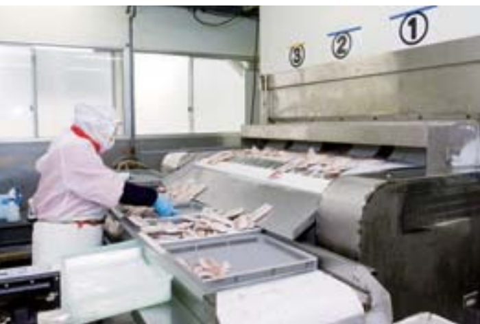
▲ベルトフリーザーを通過したイカは、凍結して出てくる。撮影時は、3種類のイカを同時に処理。これは、マーケットが求める少量多品種に対応したカイゼンの成果の一つ
