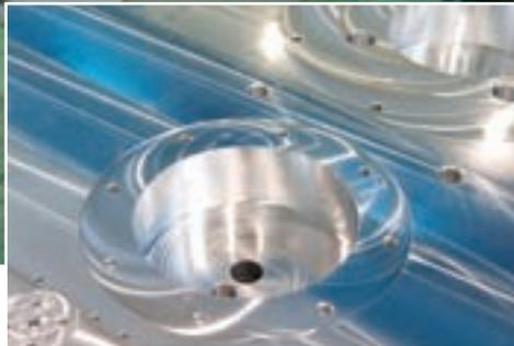
▲本杉工場で生産している大型精密部品の「真空チャンバー」。液晶のフラットパネルディスプレイを製造する装置で、高精度が求められる
