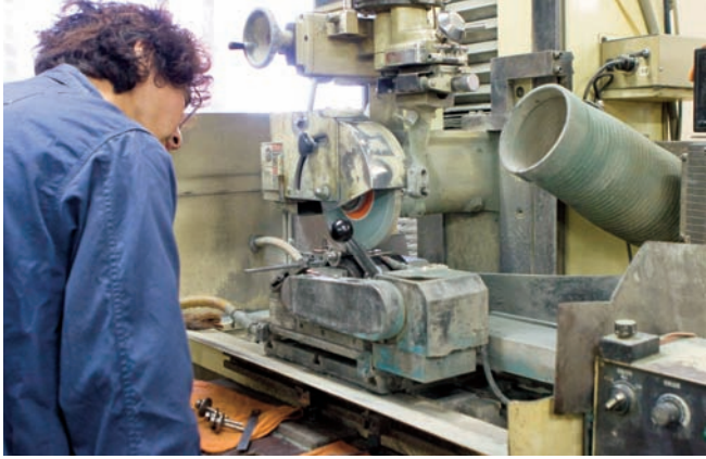
顕微鏡を使つての砥石の成形。その砥石を使つて微妙で微細な研磨をおこなう。
