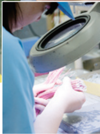
端子圧着加工された電線。肉眼による検品で高い品質が維持されている
