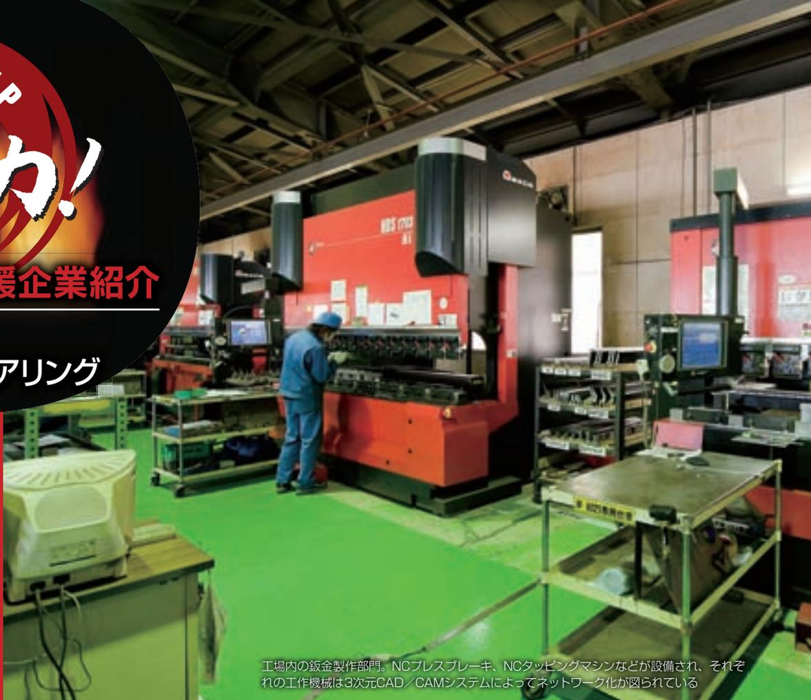
工場内の钣金製作部門。NCプレスブレーキ、NCタッピングマシンなどが設備され、それぞれの工作機械は3次元CAD／CAMシステムによってネットワーク化が図られている
