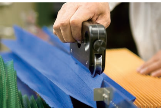
アイデア製品のアコーディオンカーテン・カット器機。市販の安価な刃が使用でき、交換も簡単
