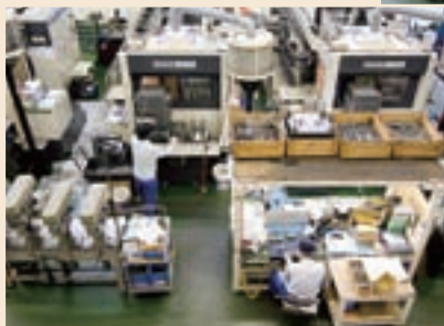
小物の部品加工場。新鋭のマシニングセンター（複合数値制御工作機械）をそろえ、高精度の加工に対応している
